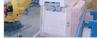
Isla robotizada para la despaleitización de las cajas de azulejos del palé. La instalación está dotada de un sistema para cortar el eventual fleje que mantiene atados los paquetes, puede quitar el cartón de separación colocado entre un piso y otro de las cajas y remueve, por último, el palé vacío.
